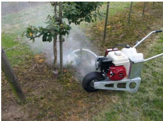
Abb. 3: Die Verbrennungsgase werden über eine Rauchglocke in das Gangsystem der Mäuse geleitet.
